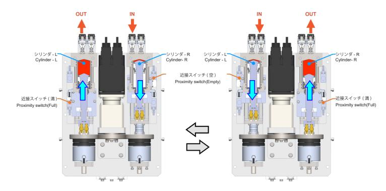
シリンジポンプユニットは、2本ピストンを防爆型の AC サーボモータにより交互に駆動することで、工業塗装に不可欠な塗料の連続供給を可能にしました。シリンダ - R に塗料を充填する間、塗装機への塗料供給は充填を済ませたシリンダ - L から供給され、この一連の動作を交互に繰り返し連続供給されます。近接スイッチによりピストンの空位置および満位置を正確に検出し反転することで、安定した塗料供給を実現しています。
