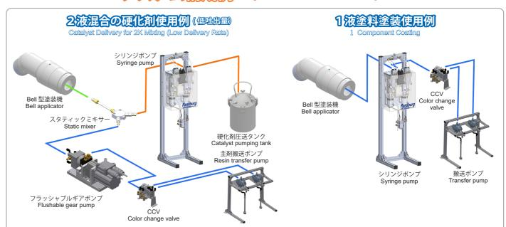
主剤はダイアフラムポンプで吸込みカラーチェンジバルブを経由しフラッシャブルギアポンプでスタテックミキサーに供給。一方、少量の硬化剤はシリンジポンプで高い精度でスタティックミキサーに供給。安定した2液混合塗装を実現します。
